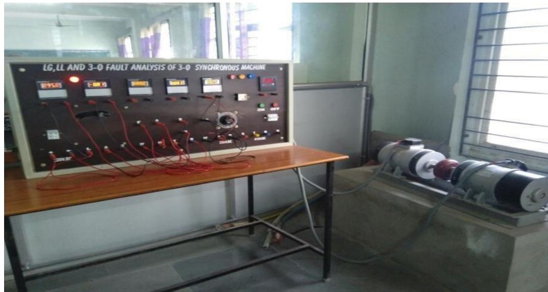
Fig:46 : 3 KVA, 415 V, 4.5 A, 1440 RPM, 3- Phase Alternator
